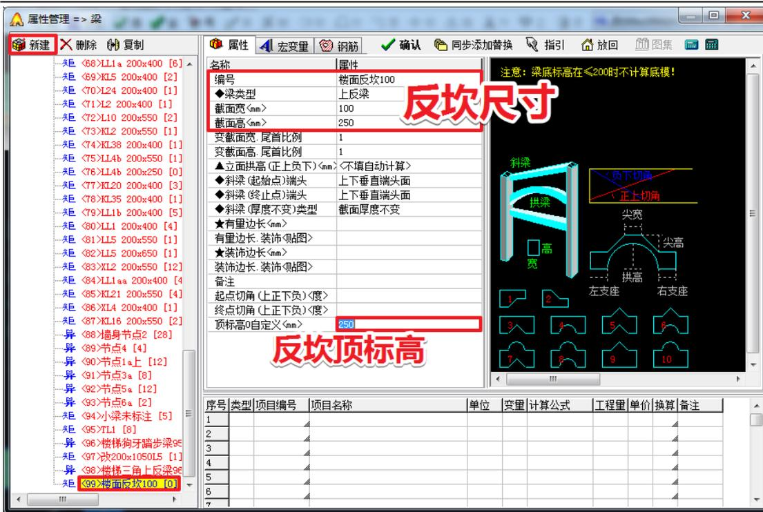
确认，直接开始绘制，当遇到 L 型反坎时，可依次选择外侧的角点，最后按空格确认（同样的，按 F3 调整反坎位置）：
