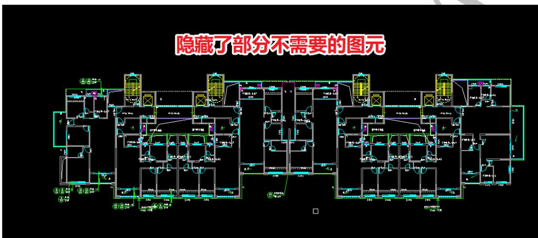
并设置好工作区和原点，原点注意设置在容易找到的位置（导入到四维后，要将图纸移动到准确位置）：
