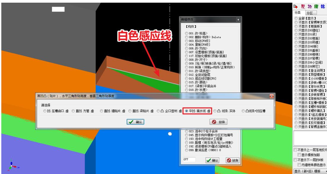
按要求设置：偏移感应线距离=25；滴水线宽度=20；滴水线厚度=10；两端长度增减取-25，确定：
