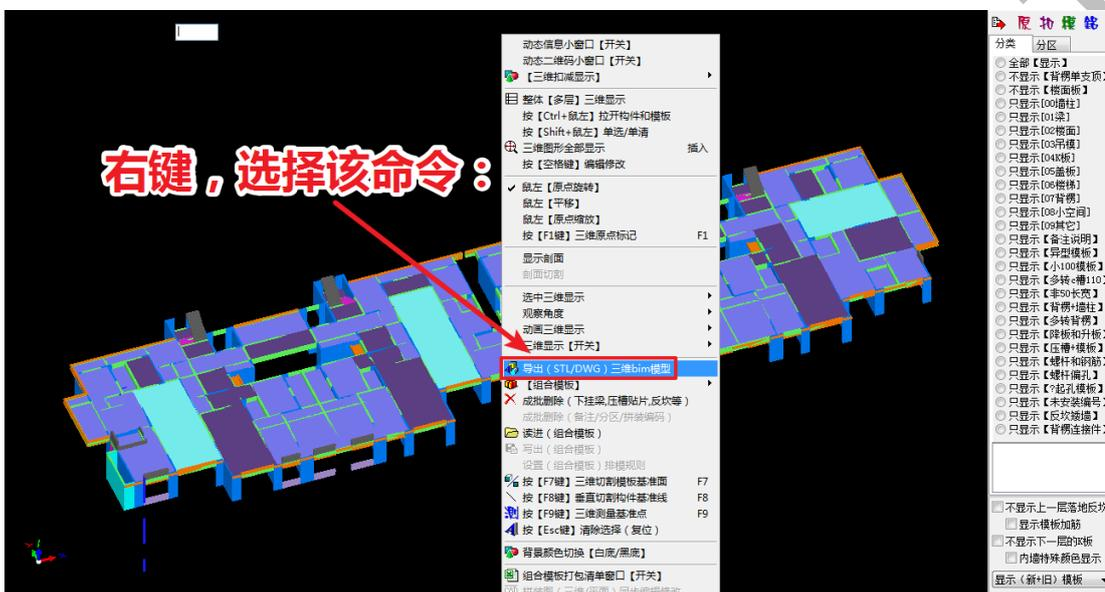
选择导出“DWG 格式三维 bim 文件（AutoCad）”，确认：
