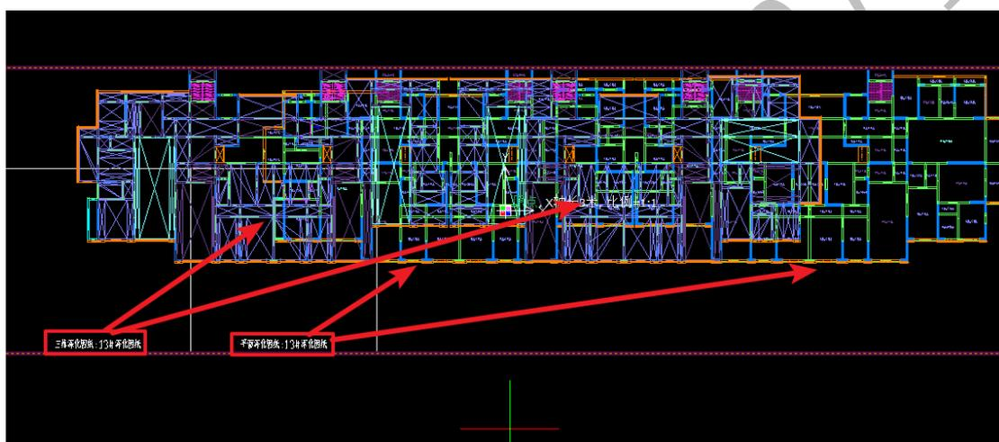
如上图所示，有时候由于图纸范围较大，二维深化底图和三维深化底图有部分图元重叠，无法分辨。遇到这种情况，我们可以用“开始”菜单下的“隐藏图层”
