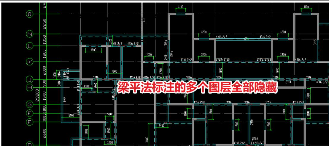
此时，点击开始菜单下的“反显图层”命令
