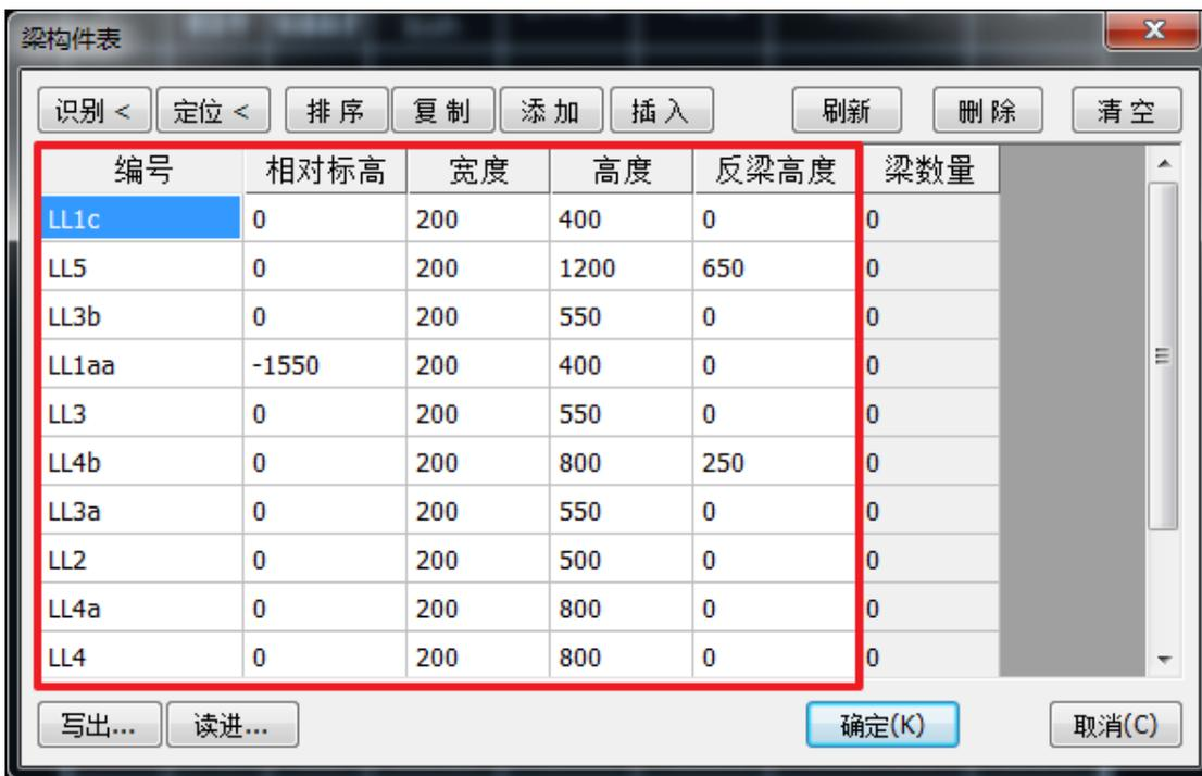
点击“确定”，则连梁表导入成功，识别梁时，软件将可以识别各编号连梁的尺寸。
