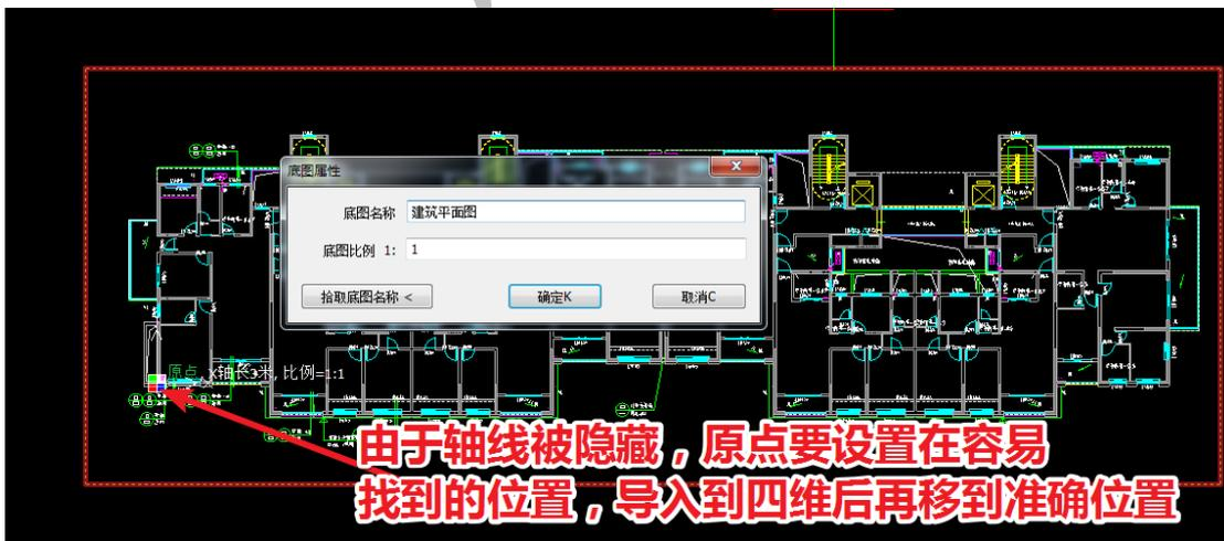
同样，使用“底图导到四维”命令将建筑平面图发送至四维，并移动其到准确位置：
